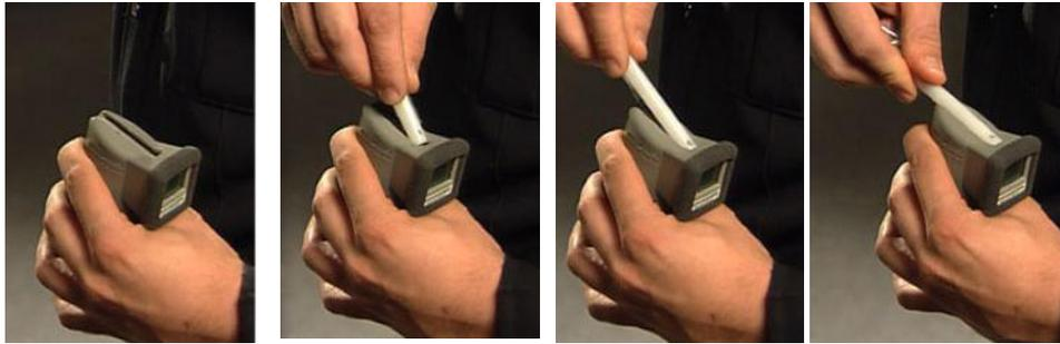
Deux petits orifices sont présents sous l'embout, sur la partie plate. Si l'embout est monté correctement, ces orifices seront placés sur le tube de prise d'échantillon et sur le tube du contrôleur de souffle.
