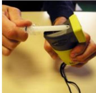
**3.** Positionner l'embout sur l'éthylotest FST par l'extrémité libérée en orientant l'orifice vers le haut puis clipser vers le bas
