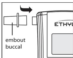
Insérez un embout buccal sur le capteur (attention changer d'embout à chaque utilisation).
